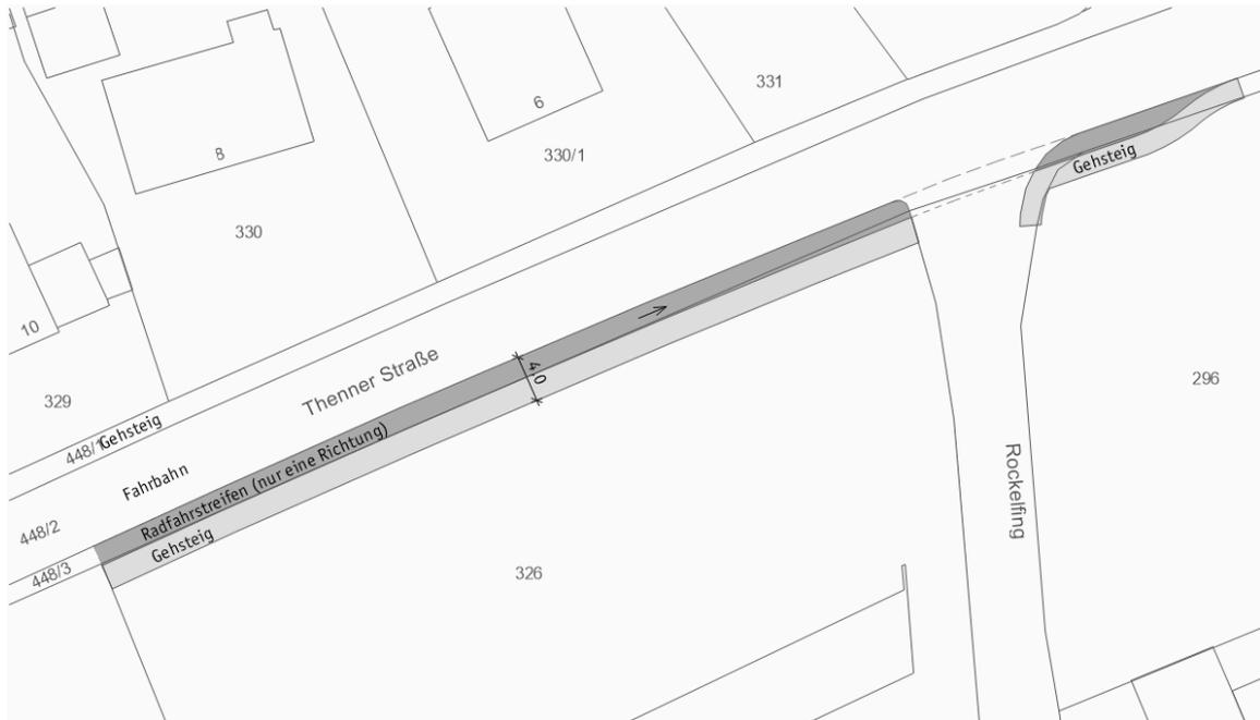
Abbildung: Radfahrstreifen (nur eine Richtung, verbindliche Nutzung)
