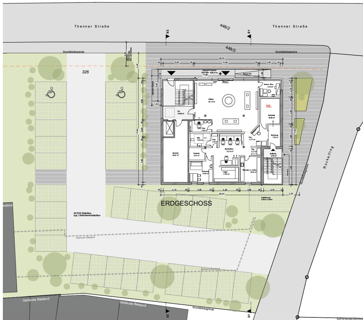
Abbildung: Ärztehaus Erdgeschoss und Freiflächenplan (Anger Groh Architekten, Dorfen)
