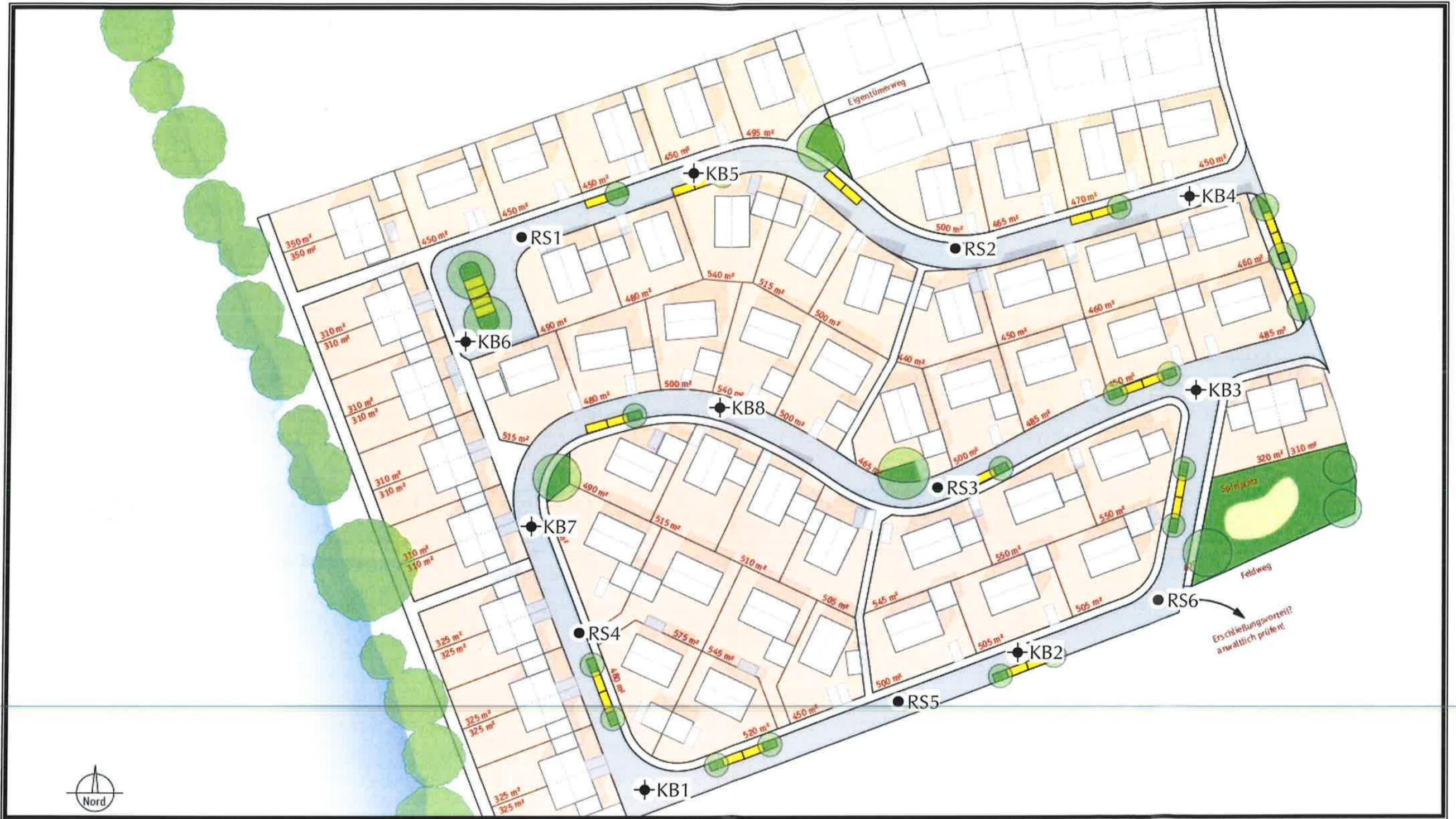
◆ Kleinbohrung      ● Rammsondierung
