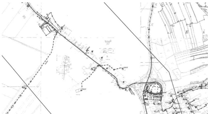
In der Ausführungsplanung der Erschließung sind Trassen für die Telekommunikation einzuplanen. In der näheren Umgebung befinden sich Kabelanlagen (siehe Abbildung).
