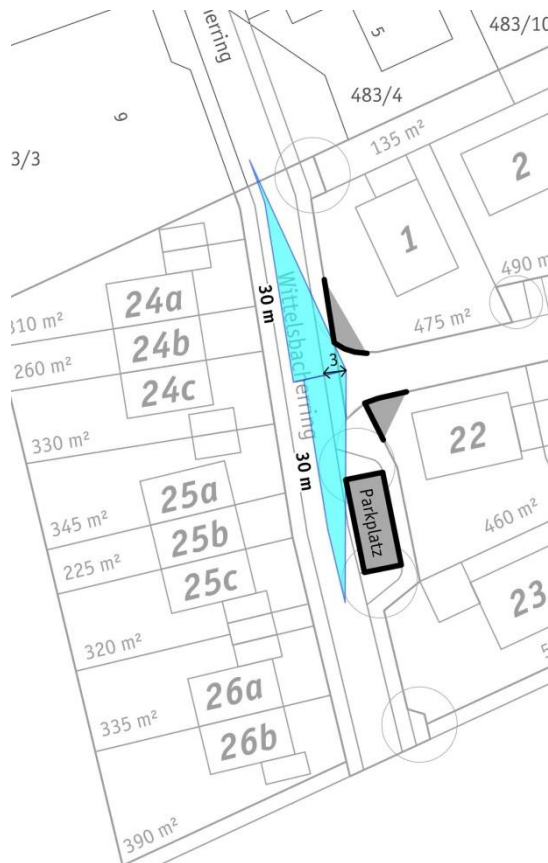
Sichtflächen westliche Einmündung
