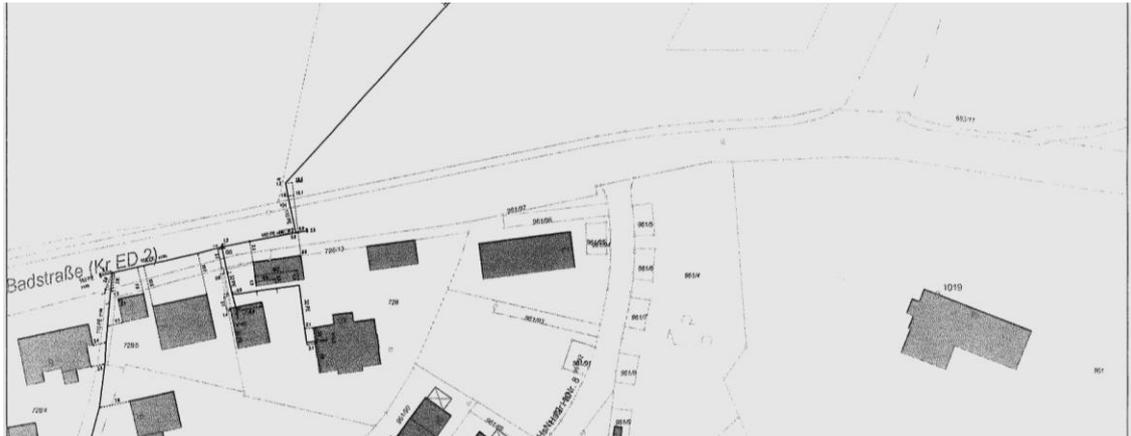
Für die Errichtung des Nahwärmenetzes muss eine Leitung unter der Kreisstraße durchgeführt werden. Für die Trasse ist die Eintragung eines Leitungsrechts notwendig (siehe Festsetzung Nr. 4.4).
