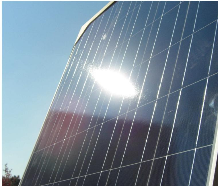
Bündelaufweitung beim Sonnentest eines polykristallinen Moduls,
